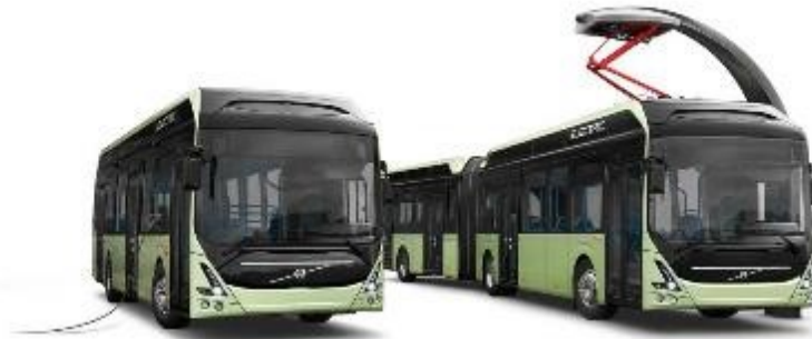
Слика 2. Просторни и визуелни изглед пуњења батерије електричних аутобуса
