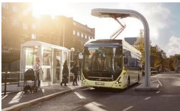
Слика 4. Аутобуско стајалиште са пуњачем за аутобусе
